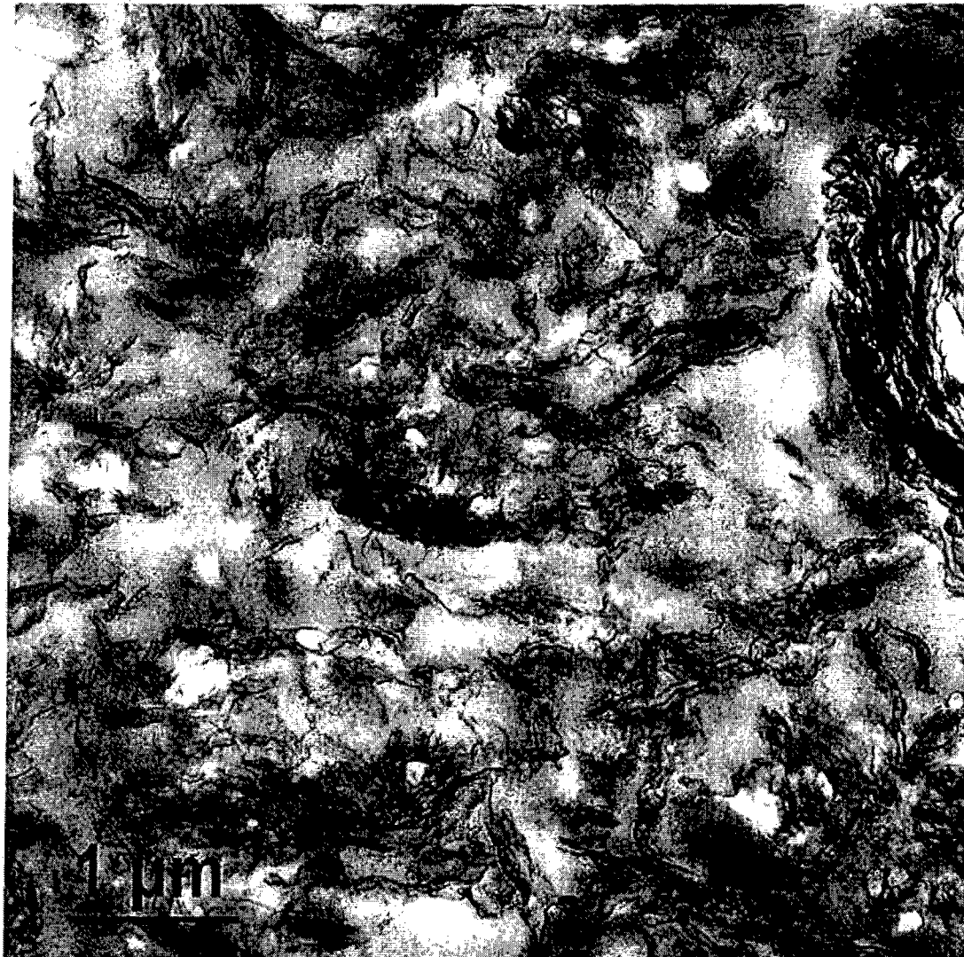
在 EVA 共聚物中具有 5wt% 的 1000\text{m}^2/\text{g} 膨胀石墨
