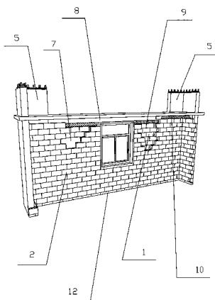
1. 一种半内包砌型全夹芯组合墙体自保温体系,其特征是,该半内包砌型全夹芯组合墙体自保温体系包括 A 型复合保温砌块自保温墙体 1, B 型复合保温砌块自保温墙体 2, 斜砌砖自保温墙体和梁保温体,门窗周围保温墙体,墙体顶端斜砌砖自保温墙体;具体构造如下:
