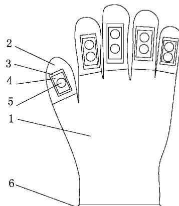
1. 一种多功能胶手套,包括胶手套,其特征在于在胶手套的手指部分套有柔性套体,柔性套体的内侧面固定有第一魔术贴,在第一魔术贴上设有第二魔术贴,第二魔术贴上缝制有钢丝球或海绵。
