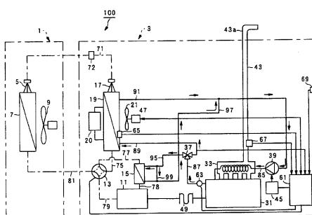
1. 一种空气调节装置，其具有：连接由发动机驱动的压缩机、四通阀、室外热交换器和室内热交换器的冷媒回路，由冷却水泵向发动机输入冷却水而冷却上述发动机的冷却水回路，其特征在于：在上述冷媒回路中，设置有冷却上述发动机的冷却水循环的辅助蒸发器；并且在上述冷却水回路中设置有，流经上述发动机的冷却水经由上述室外热交换器回流入上述冷却水泵的主冷却路径、流经上述发动机的冷却水经由上述辅助蒸发器回流入上述冷却水泵的副冷却路径以及把上述冷却水分配给上述主冷却路径和上述副冷却路径的电动三通阀，当上述冷却水温度低于目标温度时，基于上述冷却水的温度和目标温度的温度差，控制上述电动三通阀，由此，把上述冷却水分配给上述主冷却路径和上述副冷却路径的双方，或者，把上述冷却水的全部分配给上述副冷却路径，并且，降低上述冷却水泵的转速。
