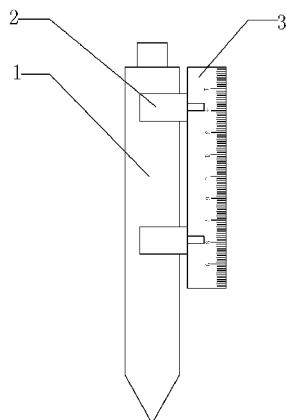
1. 尺子笔，包括笔主体，其特征是，所述的笔主体上带有一刻度尺，所述的刻度尺一侧设有刻度，另一侧设有卡环，所述的卡环为带有缺口的圆环，卡环套置在笔主体上。
