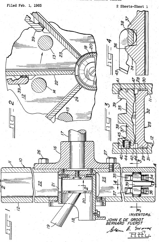
LOCK SYSTEM FOR BLASTING-MACHINE BLADES
