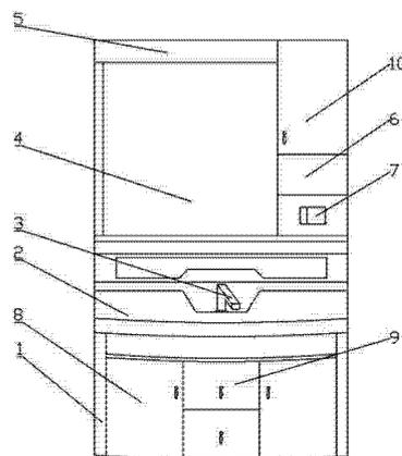
1. 一种具有大容积洗漱盆的多功能浴室柜,包括支架板(1),其特征在于所述的支架板(1)上架设有洗漱盆(2),洗漱盆的两侧以及内端都为平面,洗漱盆的外端为向外凸的圆弧面,洗漱盆内端设有水龙头(3),洗漱盆的上方设有镜子(4),镜子的上方设有照明灯(5),镜子的一侧设有置物架(6)以及电源开关(7),电源开关连通照明灯,洗漱盆的下方设有置物柜(8)以及置物抽屉(9)。
