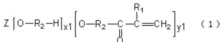
(式中、Zは水酸基を(x1+y1)個有するポリオールの残基またはポリオールのエポキシエステルの残基を表し、x1は0~2の整数、y1は2~6の整数であって、x1+y1は2~6の整数である。R1は各々独立して、水素原子またはメチル基を表す。R2は各々独立して、下記式で示される原子団Aを表す。)
