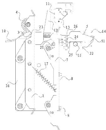
1. 一种电梯集成轿门锁异步门刀装置,包括与轿门相对固定的门刀底板,以及与轿厢相对固定的轨迹架;门刀底板上摆动安装有相互配合用于带动层门球的动刀片和解锁刀片;所述动刀片上轴接有与轨迹架相配合的提刀球;其特征在于,所述门刀底板上铰接有锁钩,在轿厢上相对固定有与该锁钩相卡合的锁栓,所述解锁刀片上设有用于拨动锁钩以改变与锁栓配合状态的拨动杆;所述门刀底板上还轴接有解锁板,所述动刀片与解锁板之间设有相互配合以带动解锁板旋转的联动部件,所述解锁板上设有随解锁板旋转以拨动锁钩解锁的拨轮。
