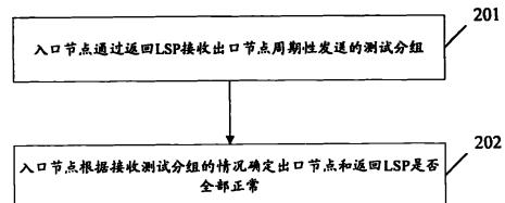
1、一种多协议标签交换网络数据面检测的方法，其特征在于，设置入口节点和出口节点可以识别的测试分组后，该方法还包括以下步骤：
