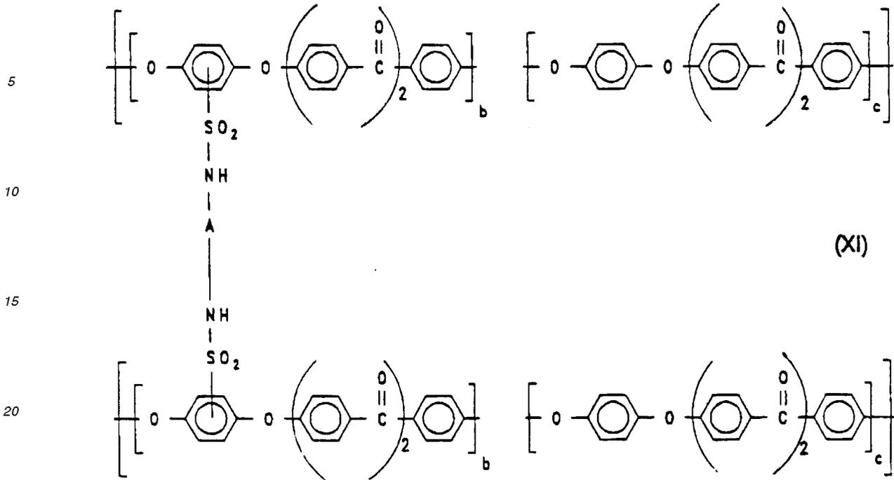
25 in der  $b = 0,5$  bis  $1$ ,  $c = 0$  bis  $0,5$ ,  $b + c = 1$  ist und A die in Anspruch 14 angegebene Bedeutung aufweist und b) einem sulfonierten Polyetherketon der allgemeinen Formel (I),
