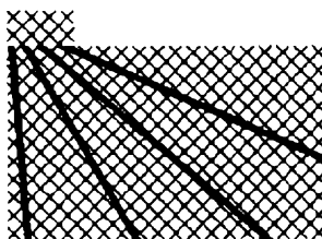
wpasowanie drutów nieołowiowych w relief podłoża przed ołowianiem
