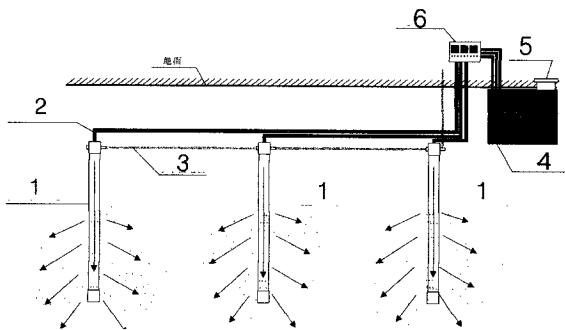
1. 一种智能离子接地系统,由离子接地极、输液管、水平接地极、智能离子供应器、离子储存器、加液盖组成,其特征是解决了土壤电阻率高、离子的腐蚀性以及离子的流失性问题。
