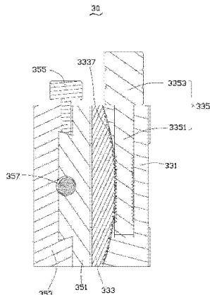
1. 一种旋转调整机构,其包括相互滑动配合的第一基座与第一滑块以及第一调节件,该第一基座包括第一滑行部,该第一滑行部上形成有第一滑行面,该第一滑块上形成有第二滑行面并于该第二滑行面上形成有配合部,该第一滑行面与该第二滑行面相对并滑动配合,其特征在于:该第一基座的侧面上还开设有调节孔,该调节孔部分穿透该第一滑行面以于第一滑行面上形成间隙孔,该第一调节件配合装设于该调节孔中且部分露出于该间隙孔外,并通过露出该间隙孔外的部分与该第二滑行面上的配合部相配合以驱动该第一滑块相对该第一基座滑移。
