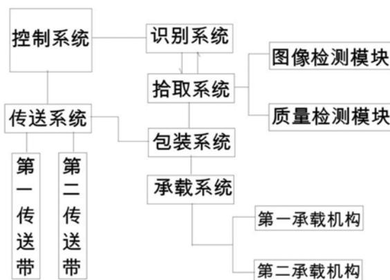
1. 一种整鞋包装盒码垛系统,其特征在于:包括控制系统、识别系统、传送系统、拾取系统、包装系统和承载系统;所述识别系统、传送系统、拾取系统、包装系统、承载系统分别与所述控制系统相连接;所述包装系统与所述传送系统相连接;所述传送系统包括第一传送带和第二传送带;所述识别系统包括条码识别系统和图像识别系统;所述拾取系统包括机械臂、以及机械臂上设置的抓取机构;所述机械臂上设置的抓取机构设有图像检测模块和质量检测模块;所述包装系统包括自动封箱系统和粘贴对应鞋品信息的条形码系统;所述承载系统包括第一承载机构和第二承载机构。
