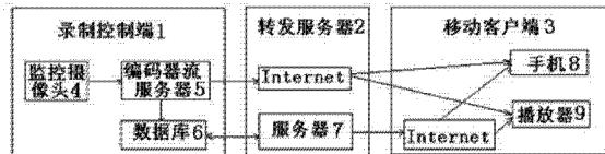
1. 一种移动终端视频监测系统，其特征在于：包括一录制控制端，其安装在一配有视频采集卡的主机上，且所述采集卡与若干监控摄像头相连，该摄像头连有一编码器流服务器，且所述编码器流服务器连有一数据库；一转发服务端，其部署在电信服务器上，通过网络与所述录制控制端连接；一移动客户端，其通过网络连接到所述转发服务端；所述转发服务端负责控制所述移动客户端和所述录制控制端之间的数据和控制信息。
