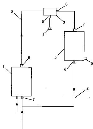
1. 一种用于热水器的节水系统,包括热水器(1)、水管(2)、温控阀(3)、喷头(4)和储水器(5),其特征在于:所述热水器(1)顶部出水口(6)的水管(2)上接有温控阀(3),所述温控阀(3)上设有两出水口(6),第一出水口(6)通过水管(2)连接到储水器(5)顶部的进水口(7)上,第二出水口(6)的端头安装有喷头(4),所述储水器(5)底部出水口(6)上的水管(2)连接在热水器(1)底部的进水口(7)上。
