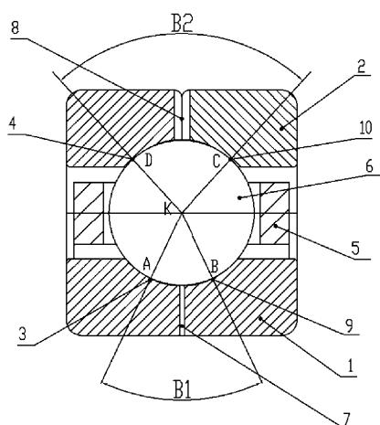
**【权利要求1】**一种不等接触角四点滚动轴承，设有内圈（1）、双外圈（2），在内圈（1）与双外圈（2）之间设置保持架（5），在保持架（5）内设置滚动体（6），在内圈（1）上对称地设置有左滚道（3）和右滚道（9），在双外圈（2）上对称地设置有左滚道（4）和右滚道（10），内圈（1）上的左滚道（3）、右滚道（9）及双外圈（2）上的左滚道（4）、右滚道（10）形成的整体滚道构成滚动体（6）的四点滚动接触滚道，其特征在于：内圈（1）上的左滚道（3）接触点A和右滚道（9）接触点B与滚动体（6）的旋转中心点K形成双接触角B1，双外圈（2）上的左滚道（4）接触点D和右滚道（10）接触点C与滚动体（6）的旋转中心点K形成双接触角B2，两个双接触角B1和B2是不相等的，当内圈（1）为活动时B1为40度～90度，B2为90度～160度；当内圈（1）为固定时B1为90度～160度，B2为40度～90度；并且内圈（1）与双外圈（2）上的两个双接触角B1和B2的角度差为20度～140度。
