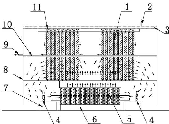
1. 一种新型箱式电机冷却方法,其特征在于:在电机内通过热管固定支板将热管沿竖直方向安装在电机壳体内定子上方,通过热管固定支板将电机分为两个相对隔离的空间,上部空间为水冷却系统,下部空间为风冷系统,其中水冷却系统的换热过程为:冷却水源通过水管由冷却水进水口进入到储水层,储水层的水通过喷嘴形成液膜并顺着热管壁流下,使冷却水与热管上部冷凝端充分换热,热管内的工作介质冷凝回流到下端蒸发端,在冷却水的作用下将热管下端蒸发端的热量带走,吸收了热量的冷却水汇集到冷却水出水口,并通过水管排出;风冷系统的换热过程为:通过电机转子两端安装的内风扇,将热空气横向掠过热管的下端蒸发端,使热空气与蒸发端充分换热,热管内的工作介质因吸收热空气的热量而蒸发,从而对热空气进行冷却,在热空气被冷却到要求的温度后,通过内风扇的强制对流作用使得降温后的空气从转子及定子的间隙中流过,对转子及定子进行冷却,保证其在安全温度范围内工作。
