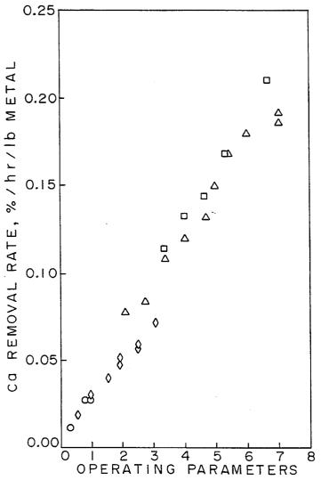
o-12" SINGLE ROTOR ◇-6" SINGLE ROTOR △-6" DOUBLE ROTOR SEPARATE GAS □-6" TRIPLE ROTOR SEPARATE GAS
