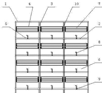
1. 一种药房置药架，设有架体，架体上设有横隔板和纵隔板，横隔板与纵隔板交叉固定连接而形成单元格，其特征在于单元格内设有置药抽屉，置药抽屉下端经滑轮和横隔板上设有的滑道滑动连接，置药抽屉是由底板、底板周边的挡板交叉固定而成，置药抽屉内设有隔板，隔板两端与挡板固定连接，底板前端的挡板上设有挂销，相对挂销下方的横隔板上设有挂环。
