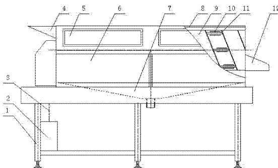
1. 一种高效马铃薯连续磨皮装置,包括机架、机壳、砂辊轴及驱动机构,其特征在于:在机壳内部水平安装有螺旋轴,在机壳内该螺旋轴下部安装有一组砂辊轴,该螺旋轴及砂辊轴由驱动机构驱动,在机壳的水平一端制有进料斗,在机壳的另一端制有出料斗。
