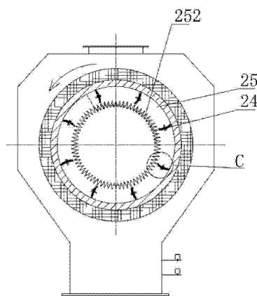
1. 一种无害化脱水器,包括进料端、脱水器本体和出料端,所述进料端、出料端分别与所述脱水器本体密封连接,其特征在于:所述无害化脱水器上分别设有高温蒸汽进口和高温蒸汽出口,所述脱水器本体为一旋转式输送容器,所述脱水器本体的内壁上布设有抄料板和破袋刀。
