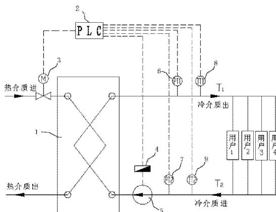
1. 一种节能板式换热机组,包括板式换热器(1)和PLC控制器(2),所述板式换热器(1)的一端接一次侧水管,另一端接二次侧水管;所述一次侧水管的换热介质进口处设有温控阀(3);所述二次侧水管的换热介质出口处设有第一压力传感器(6),换热介质进口处设有循环泵(5)和第二压力传感器(7),其特征在于,所述二次侧水管的换热介质出口处还设有第一温度传感器(8),换热介质进口处设有第二温度传感器(9);所述PLC控制器(2)的两个输入端和第一压力传感器(6)、第二压力传感器(7)相连接接收压力信号并计算压差,另两个输入端和第一温度传感器(8)、第二温度传感器(9)相连接接收温度信号并计算温差;一个输出端和温控阀(3)相连控制一次侧换热介质流量,另一输出端通过变频器(4)和循环泵(5)相连控制二次侧换热介质流量。
