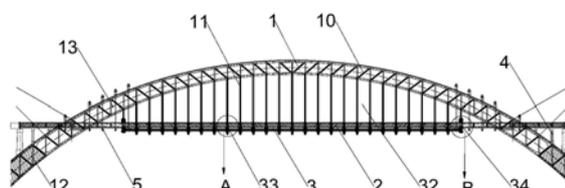
1. 一种用于大跨度拱桥主梁施工的弹性吊架,用于与拱肋(1)的跨中有吊杆区域(10)上的吊杆(11)连接,来完成跨中有吊杆区域(10)的主梁(2)的施工,其特征在于,其包括工作平台(3),所述工作平台(3)包括:
