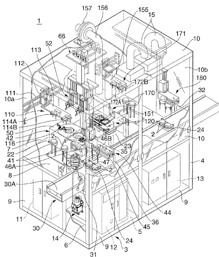
液が塗布された2枚一組の眼鏡レンズ(2)は、塗布容器(50)から取り出されるとレンズラック(120)に収納された後、光線照射装置(151)の透明板によって
