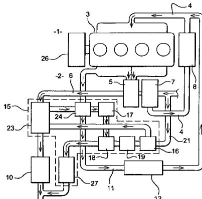
1. 一种动力总成 (1), 尤其是用于机动车辆的动力总成 (1), 所述动力总成 (1) 包括主内燃发动机 (2), 所述主内燃发动机 (2) 包括进气管线 (4) 和排气管线 (6), 其特征在于, 所述动力总成 (1) 还包括能够向所述主内燃发动机 (2) 提供额外动力的布雷顿循环系统 (15), 所述布雷顿循环系统 (15) 包括气体压缩机 (16)、燃料燃烧加热器 (17)、以及与所述压缩机 (16) 联结的涡轮机 (18), 因而, 空气被吸入到所述压缩机 (16) 中, 在所述压缩机 (16) 中, 所述空气被加压; 加压后的所述空气由于流过至少一个换热器而被进一步加热, 在所述至少一个换热器处, 加压后的所述空气与来自所述主内燃发动机的排气进行热交换; 被加热和加压后的所述空气由所述燃料燃烧加热器 (17) 进一步加热并然后通过所述涡轮机 (18) 而膨胀, 在所述涡轮机 (18) 处, 由所述涡轮机 (18) 提取的功的第一部分用于驱动所述压缩机 (16), 而由所述涡轮机 (18) 提取的所述功的第二部分用于提供额外的能量。
