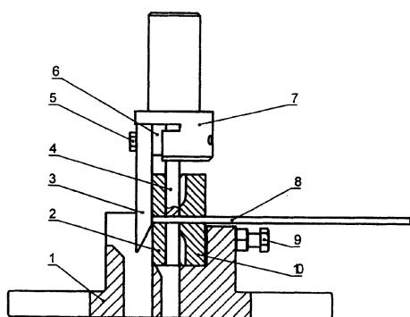
1. 一种钢丝下料的冲压剪切装置，定模连接在模座上，动模连接在模柄上，模柄滑动配合在模座上竖立设置的滑轨上，其特征在于：所述定模由第一定模（10）、第二定模（2）和位于两个定模之间的两块垫板（11）固定连接构成，动模（4）滑动配合在第一定模（10）、第二定模（2）以及两块垫板（11）之间的空腔中，第一定模（10）、第二定模（2）上对应设有用于限制钢丝位置的通孔，一个定位板（3）与模柄（7）连接，定位板（3）的长度超过动模（4）的长度，定位板（3）与第二定模（2）的外侧滑动配合；动模（4）的剪切刃端设有半圆形凹槽与第一定模（10）、第二定模（2）上的用于限制钢丝位置的通孔对应，模座（1）上设有两个分别位于动模、定位板下方的落料槽；所述第二定模（2）与动模（4）的厚度分别为钢丝的下料长度。
