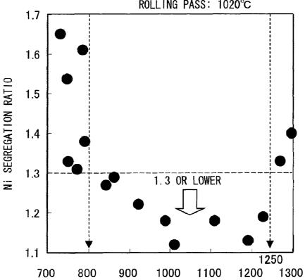
TEMPERATURE BEFORE FINAL ROLLING PASS IN FIRST HOT ROLLING, °C
