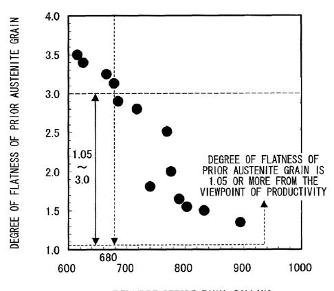
TEMPERATURE BEFORE FINAL ROLLING PASS IN SECOND HOT ROLLING, °C
