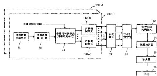
1. 一种多载波 CDMA 无线电传输方法，其中对每个信息符号进行复制，使如此获得的信息符号沿着频率轴排列，沿着频率轴将该如此获得的信息符号乘以一个扩散码，以将这些信息符号扩散到具有不同频率的多个副载波成分中，从而进行信息的多路传输，所述方法包括如下步骤：
