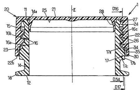
1. 一种用于容器的封闭系统，包括帽(20)和限定容器开口的环(10)，所述帽(20) 和环(10)适用于螺旋啮合以密封所述开口，所述帽(10)包括基本为圆形的顶壁(21)，从所述顶壁(21)延伸有向下的环形裙边(22)，所述裙边(22)具有环形的底部边缘(22b)和带有螺纹(26)的径向内表面(24)，所述环(20)具有形成所述开口的环形缘(11)、径向向外突出至径向环形外表面(17b)的环形的凸缘(17)、以及与位于所述环的所述凸缘与所述环形缘之间的所述帽的所述螺纹(26)互补的螺纹(16)，其特征在于，所述帽的所述裙边(22)包括至少一个环形的阻挡部件(30、34)，所述阻挡部件(30、34)从所述径向内表面(24)突出，并且适用于在基本径向的方向上靠在所述凸缘的所述径向最外表面(17b)的全部外围上。
