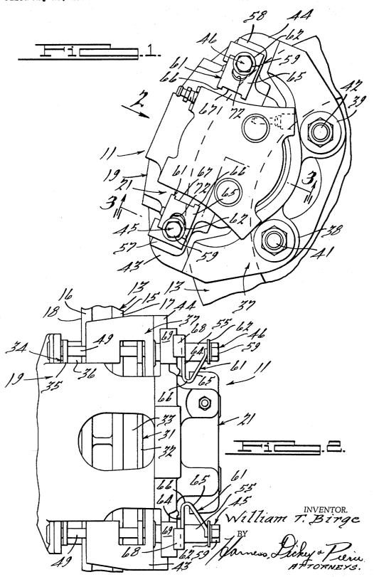
DISK BRAKE EMBODYING CALIPER POSITIONER
