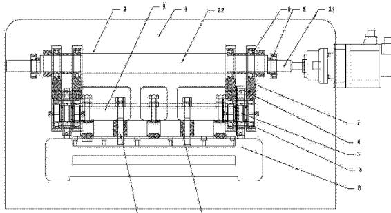
1. 一种异形袋模切制袋机的模切装置,包括机架(1)、偏心轴(2)、滑块(3)、直线导轨(4)、安装轴承(5)和模架(6);偏心轴(2)两侧的外圆柱(2.1)各通过一安装轴承(5)安装在机架(1)上;其特征它还包括传动座(7)、传动座轴承(8)、联杆(9)和导杆(10);在联杆(9)两端各套装有一滑块(3),直线导轨(4)安装在机架(1)上并和滑块(3)连接使滑块(3)只能上、下运动;在滑块(3)的两侧的联杆(9)上通过传动座轴承(8)各安装连接有一传动座(7),传动座(7)另一端通过传动座轴承(8)连接安装在偏心轴(2)的内圆柱(2.2)上,模架(6)通过导杆(10)连接安装在联杆(9)上。
