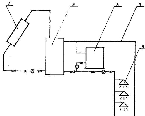
1. 一种太阳能热泵一体化热水系统,其特征在于:该系统以太阳能集热器直接加热为主、以空气源热泵加热为辅的一体化热水系统,该系统用输送水管将太阳能集热器、保温循环水箱和空气源热泵相连接,以太阳能集热器将水加热、由输送水管将热水输送到保温循环水箱、再由保温循环水箱输送到各用水点供用户使用。
