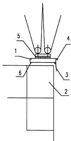
1、一种集装箱吊具，包括吊具主体、安装在吊具主体上的导向板、安装在主体下方且与集装箱的锁孔对应的扭锁，其特征在于，还包括监控扭锁与锁孔位置关系的摄像头、与摄像头相连的显示屏、以及吊具旋转部，所述摄像头安装在主体上且与导向板位于同一侧。
