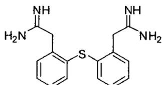
実施例6に記載の手順に従い、重要な改変ではないが、2-(6-(2-シアノエチル)フェニル)チオ-1-(2-シアノエチル)ベンゼンの代わりに2-(6-(シアノメチル)フェニル)チオ-1-(シアノメチル)ベンゼンを用い、2-(6-(アミノメチル)フェニル)チオ-1-(アミノメチル)ベンゼンを無色固体として収率90%で得た。 $^1\text{H}$  NMR (300 MHz,  $\text{CD}_3\text{OD}$ ) 7.53-7.32 (m, 6 H), 7.18 (dd,  $J = 7.6, 1.5 \text{ Hz}$ , 2 H), 4.08 (s, 4 H);  $^{13}\text{C}$  NMR (75 MHz,  $\text{CD}_3\text{OD}$ ) 170.9, 135.8, 134.3, 133.6, 132.5, 130.9, 130.0, 37.8; MS (ES+)  $m/z$  299.3 ( $M+1$ ).
