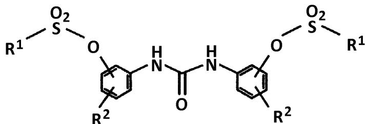
（式中、R<sup>1</sup>は、置換若しくは無置換のアルキル基、アラルキル基又はアリール基を表し、R<sup>2</sup>は、水素原子又はアルキル基を表す。）、該保護層が、シラン変性アクリル系樹脂を含有し、該シラン変性アクリル系樹脂が、下記(a1)、(a2)及び(a3)を(b
