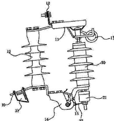
1. 一种油田供电线路自动可投式避雷装置,包括一绝缘支架(10),其特征在于所述绝缘支架(10)的上端连接设置一上静触头连接件(11),其下端设置一下接地静触头(14),所述上静触头连接件(11)和下接地静触头(14)与一氧化锌避雷器(20)的两端连接设置,所述氧化锌避雷器(20)的下端设置一热爆式脱离器(21)。
