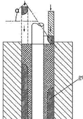
1. 一种反挤压模具,其特征是:包括反挤压筒(26)、反挤压芯轴(27)和中空的减径减壁反挤压冲头(28),以使用方向为基准,反挤压芯轴(27)固定设于反挤压筒(26)内,中空的减径减壁反挤压冲头(28)纵向能够运动插设于反挤压筒(26)内,所述中空的减径减壁反挤压冲头(28)外侧壁紧贴反挤压筒(26)内侧壁,反挤压芯轴(27)位于中空的减径减壁反挤压冲头(28)内,所述中空的减径减壁反挤压冲头(28)下端壁上设有至少一个与待成形管台位置和大小匹配的半圆弧结构,该半圆弧结构与中空的减径减壁反挤压冲头(28)下端开口连通,所述中空的减径减壁反挤压冲头(28)下端开口所在平面为与其轴心线不垂直的斜面,至少一个半圆弧结构位于该斜面远离挤压模的一侧。
