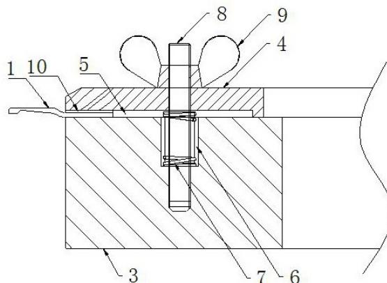
1. 一种薄壁零件检测用定位工装，其特征在于，所述薄壁零件呈圆弧形状，该薄壁零件的外缘处沿周向设有若干U形槽；所述薄壁零件检测工装包括底座和环形压板，所述环形压板位于底座上方，该环形压板与底座之间形成有压紧间隙，且该环形压板上沿周向设有若干通孔，所述底座呈圆盘状，该底座顶面设有与若干通孔一一对应的若干容置槽，各容置槽槽底设有螺纹孔，且各容置槽中设有弹簧，该弹簧一端抵于环形压板底面，另一端抵于容置槽槽底，所述通孔中穿设有双头螺钉，该双头螺钉的下端穿过弹簧与螺纹孔连接，且该双头螺钉的上端连接有蝶型螺母。
