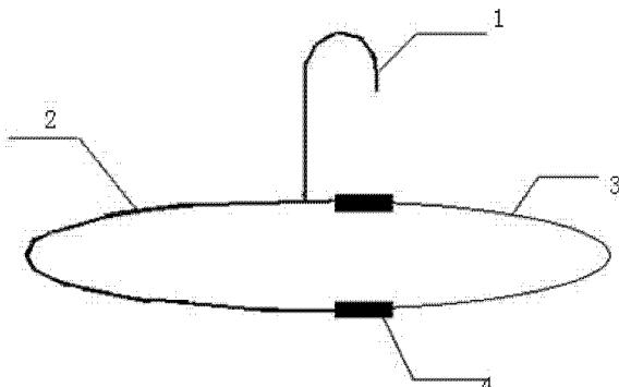
1. 一种可伸缩晾衣架，包括挂钩(1)和衣架本体，其特征是，所述的衣架本体包括空心套杆(2)、实心杆(3)、螺旋卡圈(4)，所述的空心套杆(2)直径大于实心杆(3)，所述的实心杆(3)可以在空心套杆(2)内滑动。
