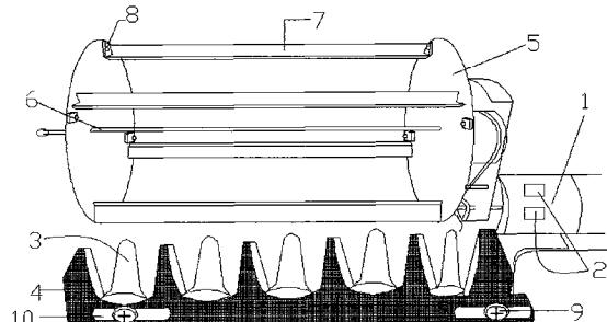
1. 一种迷你型割草机,包括割草机本体以及安装在所述割草机本体侧面的手柄(1),所述的手柄(1)内安装了电机(2),其特征在于,所述的割草机本体包括切割装置及用于输送割断物的输送装置,两者都与电机(2)相连;所述的切割装置包括一定刀片(3),其通过活动连接件与动刀片(4)相连,所述的输送装置包括两个相对放置的转盘(5),一旋转轴(6)贯穿两转盘(5)的中心线并用螺栓(8)固定,所述的转盘(5)上固定有若干个环形阵列的叶片(7),叶片(7)轴向延伸至另一转盘(5)并固定。
