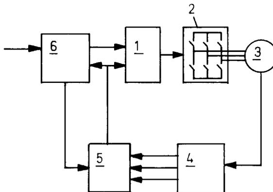
1. 用于在永久励磁的马达中借助控制设备和变流器监控和修正无传感器的转子位置识别的方法,其特征在于,在马达(3)运行期间,借助基于电感的识别设备(4,5)探测转子位置;并且通过监控/修正设备(6)在基于电感的信号的二义性方面监控所述转子位置并且必要时修正出现的角度误差,其中改变所述马达(3)中的电流。
