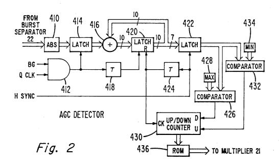
PHASE LOCKED LOOP SYSTEM INCORPORATING AUTOMATIC GAIN CONTROL
