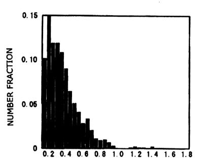
GRAIN SIZE OF RETAINED AUSTENITE GRAIN (µm)
