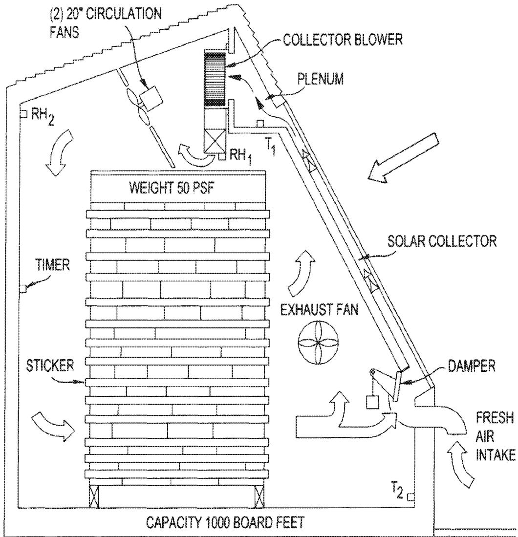
FIG. 8 ALTERNATIVE CONFIGURATION OF THE HYBRID KILN
