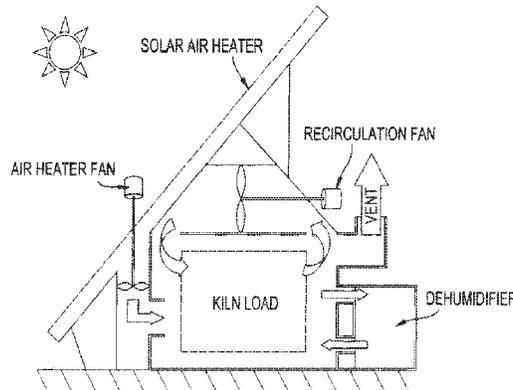
**SCHEMATIC OF THE HYBRID SOLAR KILN**
