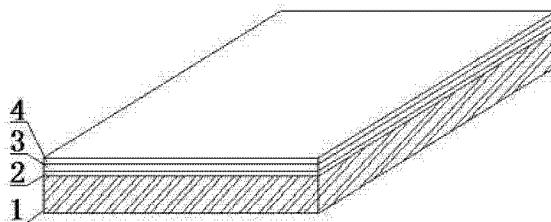
1. 一种建筑装饰用稀土陶瓷涂覆铝单板，其特征在于，所述铝单板由铝基材、钝化底层、硅酸盐系陶瓷底漆层和稀土改性陶瓷面漆层经 180~220℃温度烘烤 10~15 分钟固化而成。
