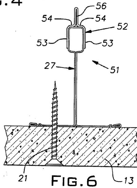
**EXTENDED SHORT SPAN TEE FOR DRYWALL CEILING**
