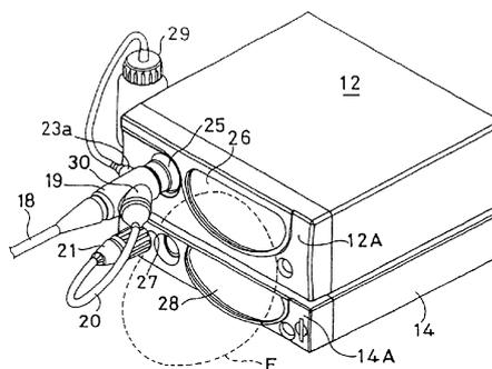
1、一种内窥镜的连接装置，
