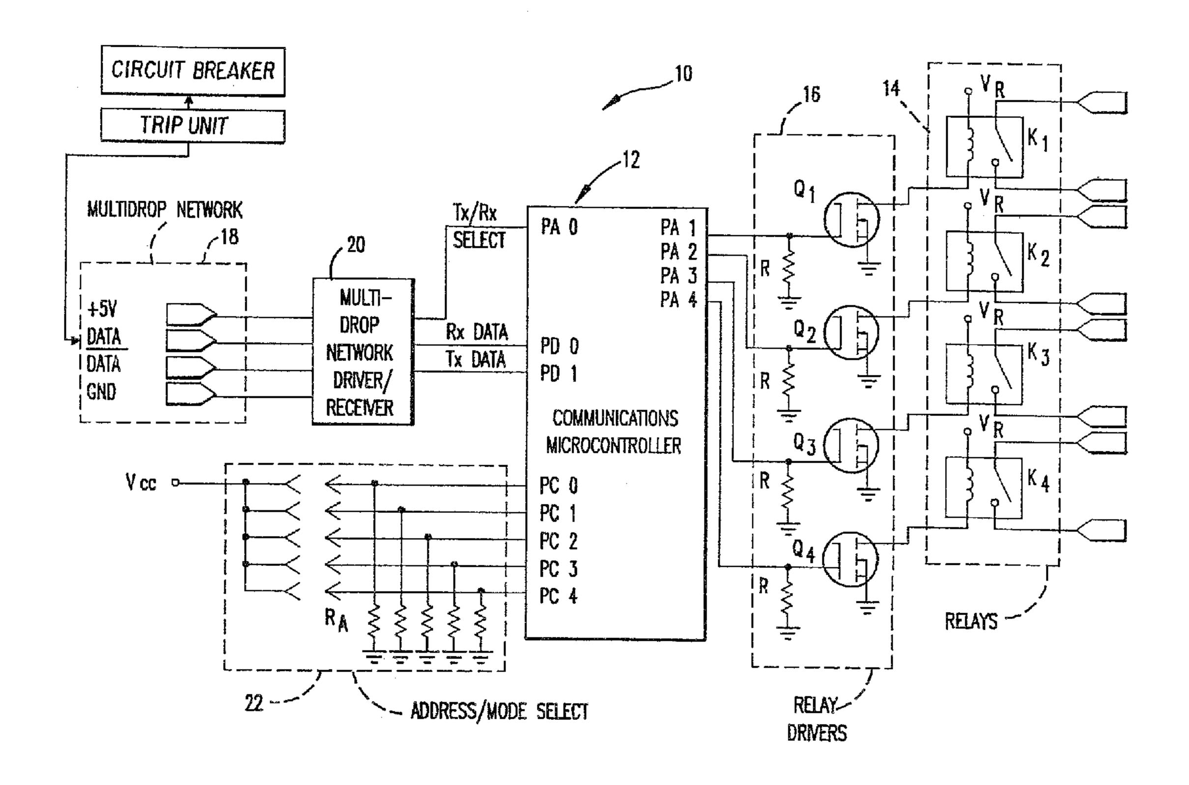
(57) On décrit un module (10) de relais adressable servant à commander une multiplicité de sorties (14) de relais associées à un système de disjonction électronique au moyen d'une unité d'excitation afin de surveiller les fonctions du système ou les paramètres du réseau. Le module (10) de relais est relié à un réseau de communications network (18) through which data
